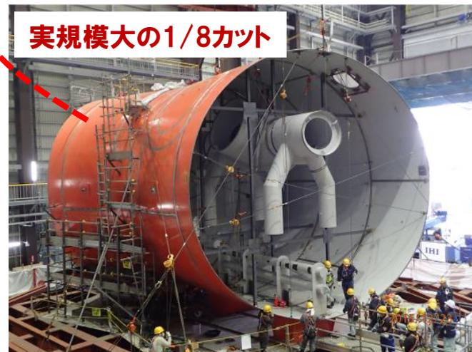
原子炉格納容器下部の実規模試験体
