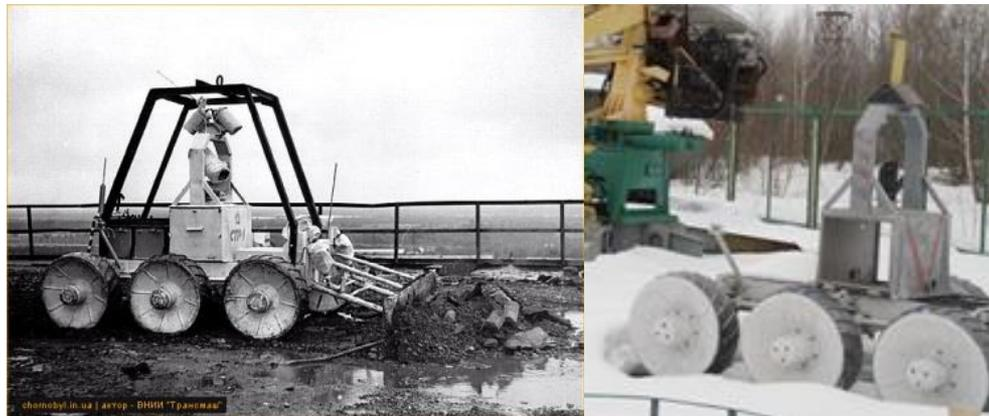
汚染瓦礫を除去するSTR-1（左）とその残骸（JAEA川妻氏提供）
