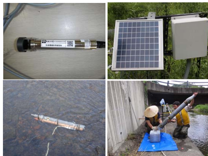
図2 観測機器、浮遊砂サンプラー
