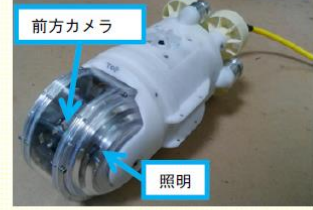
※：原子炉圧力容器を支える基礎 <水中遊泳式遠隔調査装置>
