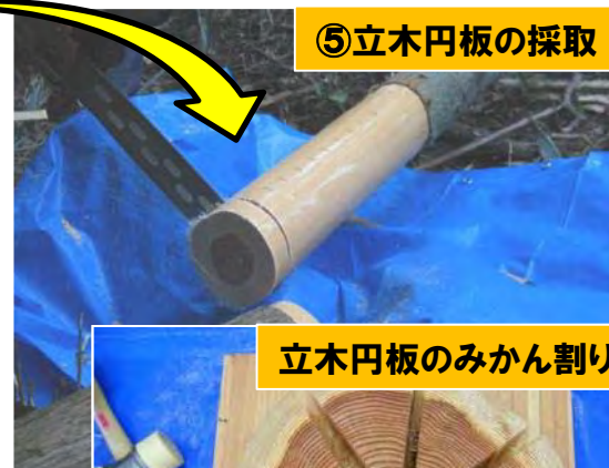
⑤立木円板の採取 →みかん割り, 心材と辺材の分離, 分析へ
