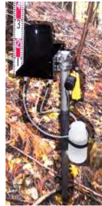
林内雨量計 + 降雨採取 (2 L)
