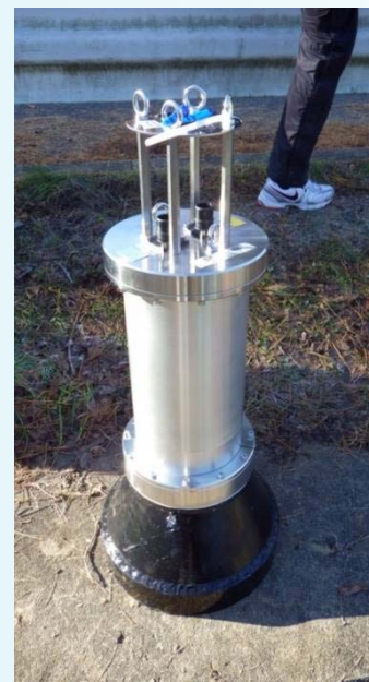
水中ガンマ線スペクトロメータJ-subDと組み合わせて放射能 (Bq/kg-wet) を評価
